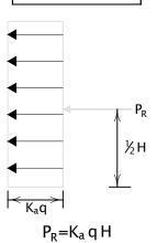
SEISMIC SURCHARGE PRESSURE
